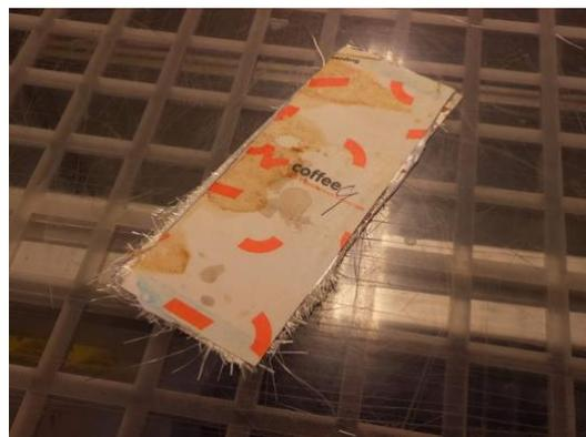
*Figura 1 - Amostra de compósito PPL-PS-PS-GF-PS-PS-PPL obtida por prensagem a quente*
